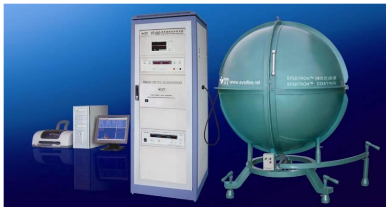
Mess-System für spektrale, farbmimetrische und elektrische Parameter von LED-Lampen und LED-Leuchten
