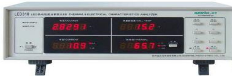
Elektronischer Analysator zur Messung von LED-Junction-Temperatur, thermischem Widerstand und elektrischen Parametern von LEDs
