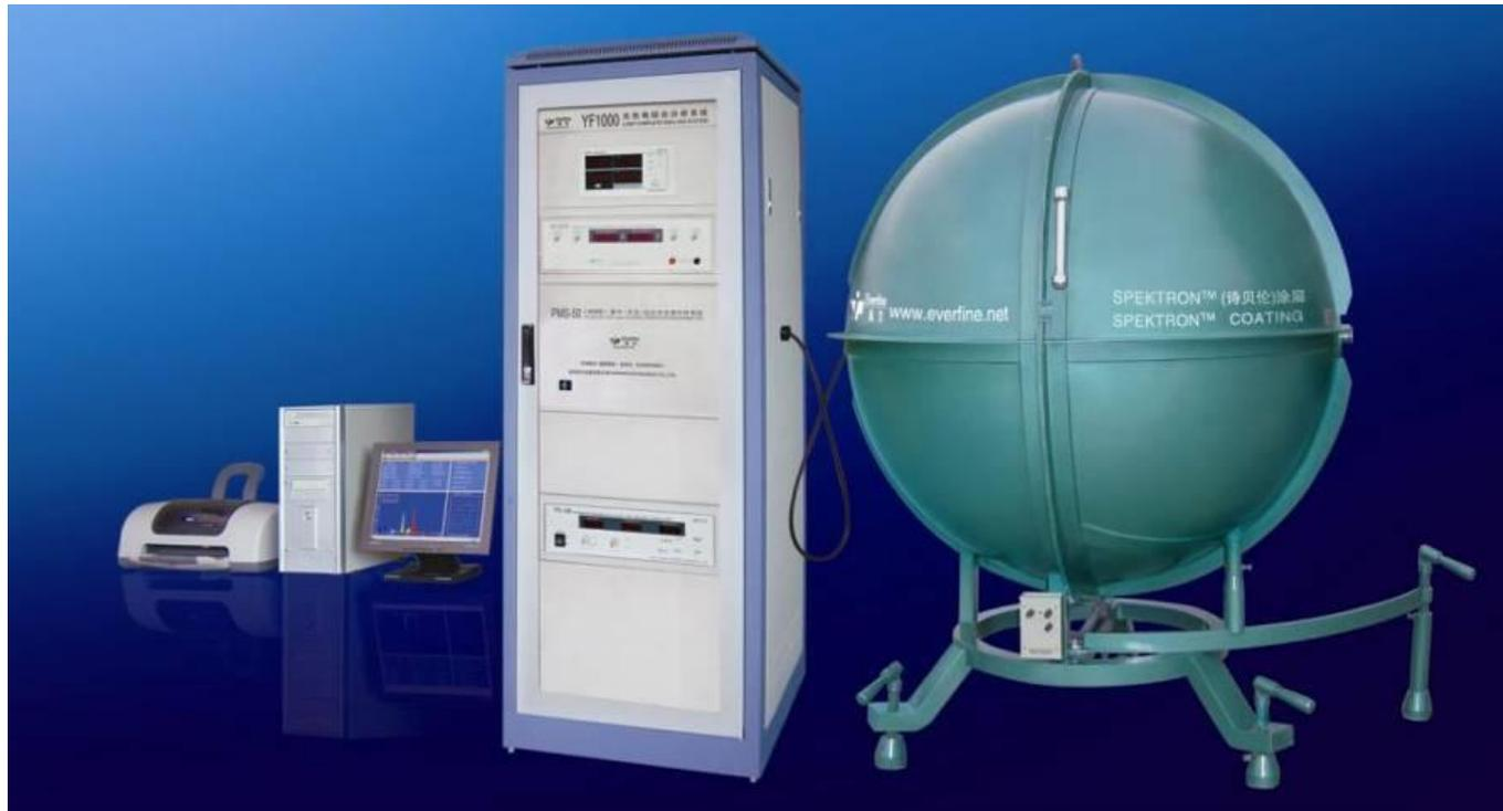
Mess-System für spektrale, farbmétrische und elektrische Parameter
