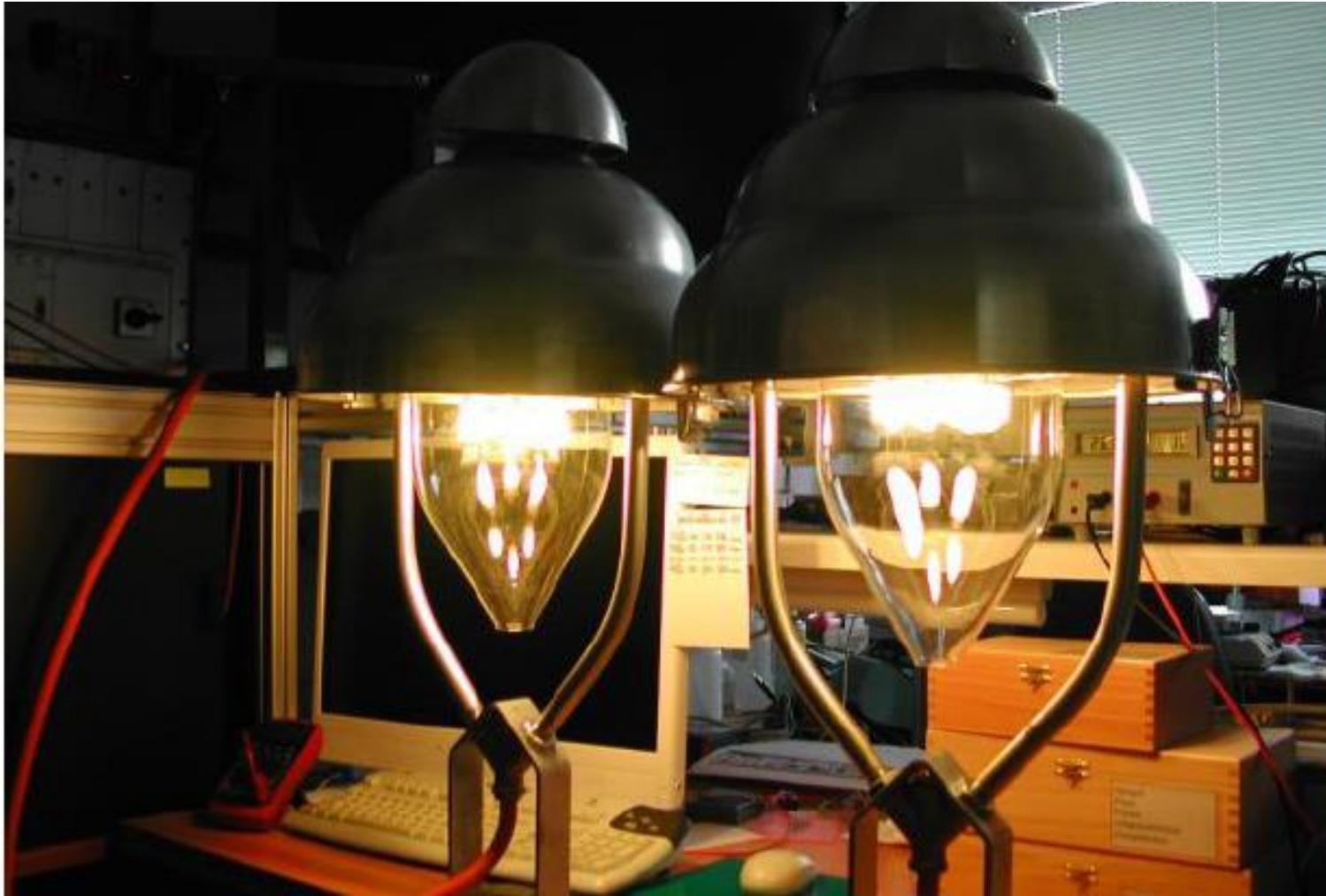
**Herkömmliche 4-flammige Gasaufsatzleuchte links und LED-Gasersatzleuchte rechts**
