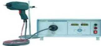
ESD (Electrostatic Discharge) –Testgerät
