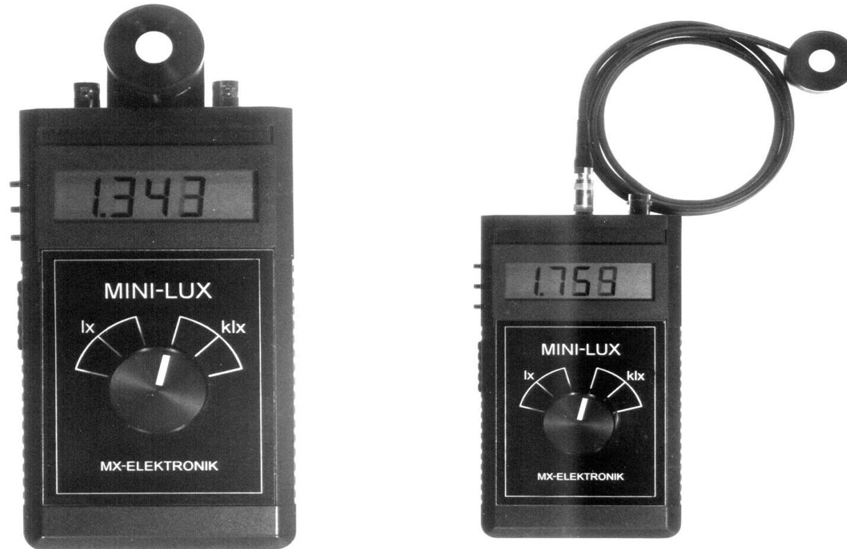
MINILUX-Geräte. Silizium-Photoelement mit  $V(\lambda)$ - und Kosinus-Korrektur gemäß DIN 5032, Klasse B
