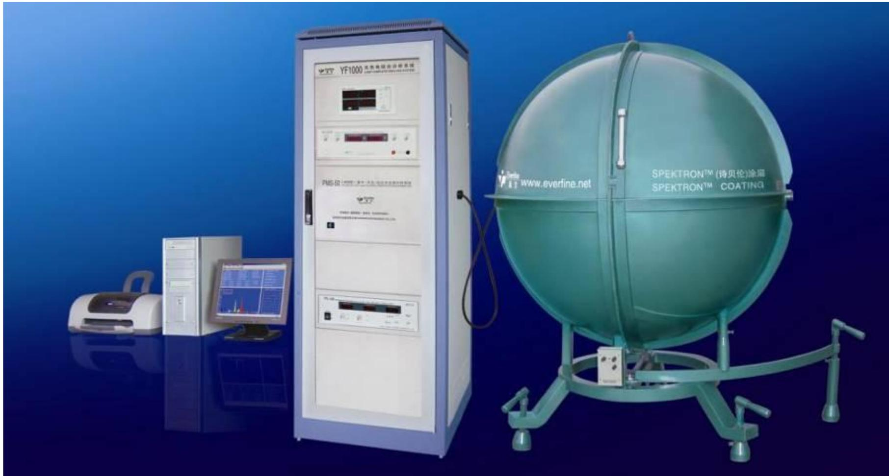
Mess-System für spektrale, farbmétrische und elektrische Parameter
