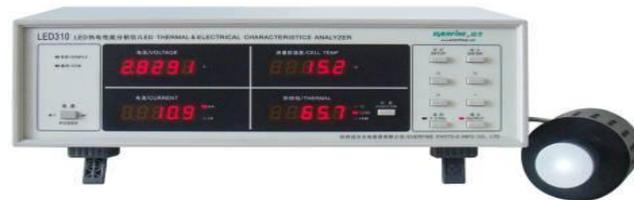
Elektronischer Analysator zur Messung von LED-Junction-Temperatur, thermischem Widerstand und elektrischen Parametern von LEDs
