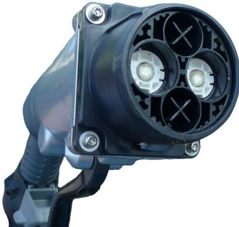
CHAdeMO-Schnellladesystem mit Gleichstrom – in Japan, USA und auch in Europa eingeführt - ist der Handelsname einer markenübergreifenden elektrischen Schnittstelle eines Batteriemanagementsystems für Elektroautos.
