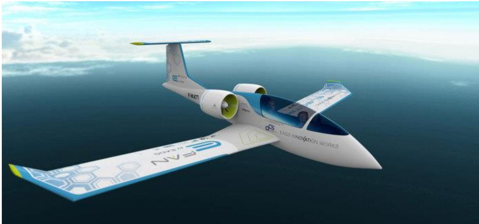
**Bis zu einer Stunde kann der E-Fan in der Luft bleiben. Er erreicht eine Spitzengeschwindigkeit von 220 Kilometern pro Stunde.**
