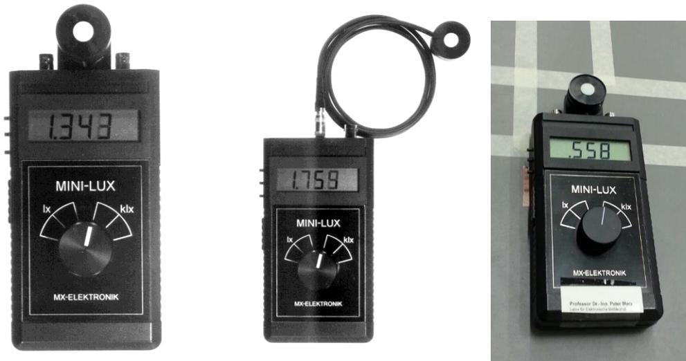
Bild 2. Digitalluxmeter, rechts Messung auf dem Sporthallenboden
